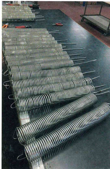
Parti di resistenze in fase di assemblaggio
